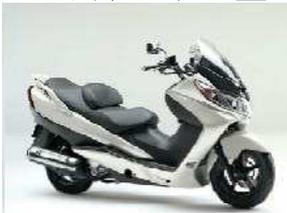
いわゆる「スクーター」タイプであり、排気量が 250cc を超えるものはビッグスクーターとも呼ばれている。このタイプでは両足をシート下前方の台にのせて走行する。ミッションはオートマチックタイプ。
